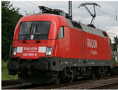
Elektro-Lokomotive: Die Oberleitung stellt nur einzige Verbindung zwischen der Lok und der Spannungsquelle (dem Elektrizitätswerk) her!
